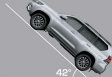
Угол преодолеваемого уклона
